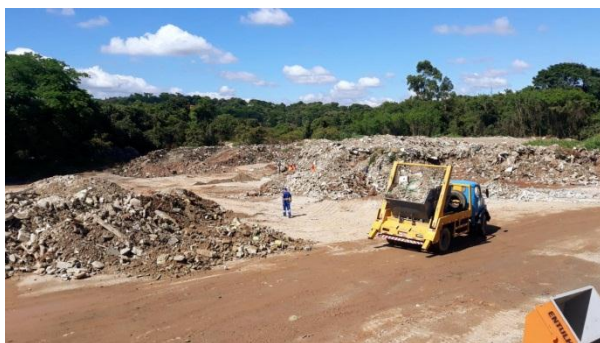
Figura 05: Pátio de segregação da URRCC, onde é possível observar a presença de grande quantidade de resíduo não passível de britagem. Fonte: Autor, 2018.
