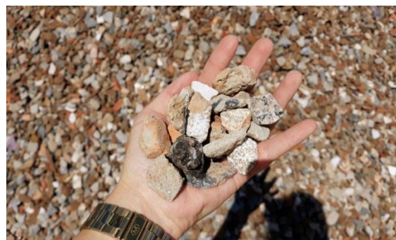
Figura 06: Brita 2 – RCC reciclado na Usina de Betim, MG. Fonte: Autor, 2018.
