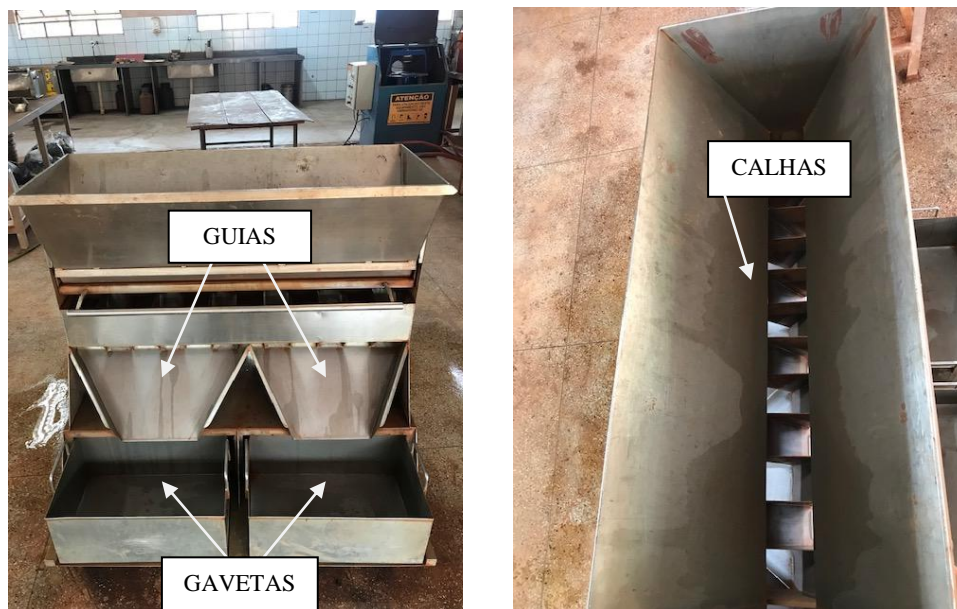
Figura 2 – Características físicas do Quarteador da marca Dialmática, em que: (a) as guias por onde passam as amostras; e as gavetas que recebem as amostras já separadas; e (b) as calhas responsáveis pela separação das amostras. Fonte: Autoria própria (2018)
