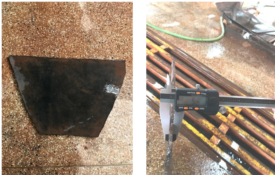
Figura 3 – Características do material de descarte utilizado como redutor do ruído, em que: (a) formato da borracha que foi adaptada no quarteador; e (b) aferição da espessura do material. Fonte: Autoria própria (2018)
