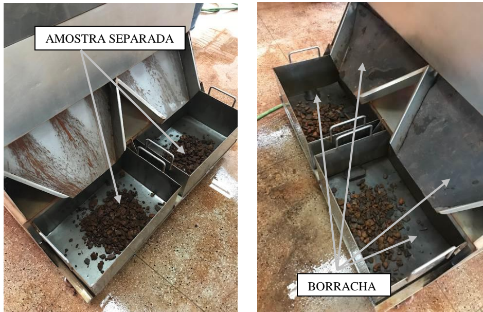
Figura 5 – Quarteador da marca Dialmática depois da separação das amostras: (a) guias e gavetas do quarteador antes da instalação das borrachas; e (b) guias e gavetas do quarteador depois da instalação das borrachas. Fonte: Autoria própria (2018)
