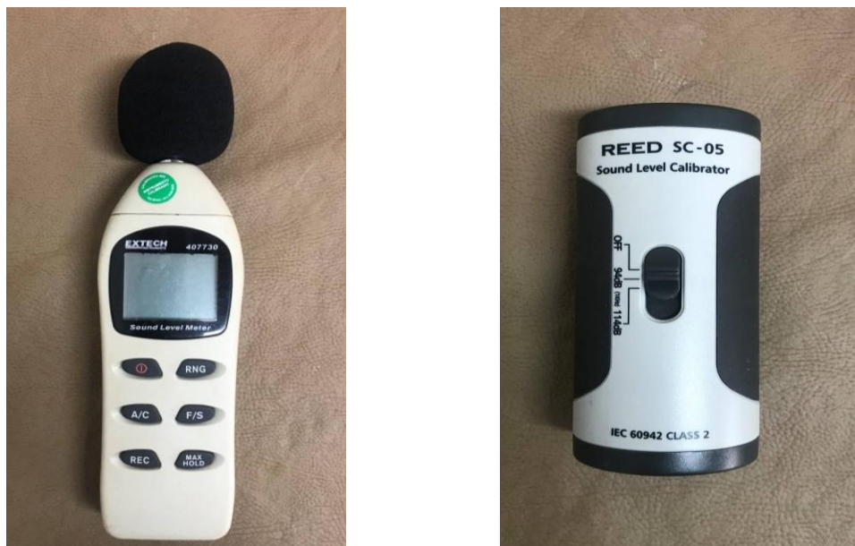
Figura 1 – Aparelhos utilizados para realizar as medidas pontuais de ruído: (a) Decibelímetro da marca Extech; e (b) calibrador do decibelímetro da marca Reed .
