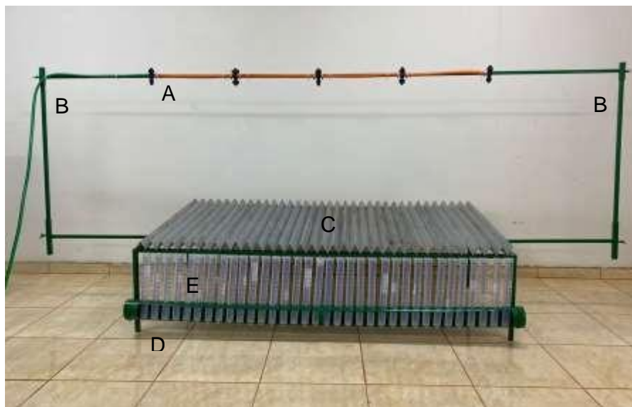
Figura 1. Mesa padronizada para teste de uniformidade de distribuição de líquido: (A) Conjunto de peças para pulverização; (B) barras de semifixas para controlar altura de sobreposição; (C) chapas de aço galvanizados; (D) suporte para provetas; (E) provetas.
