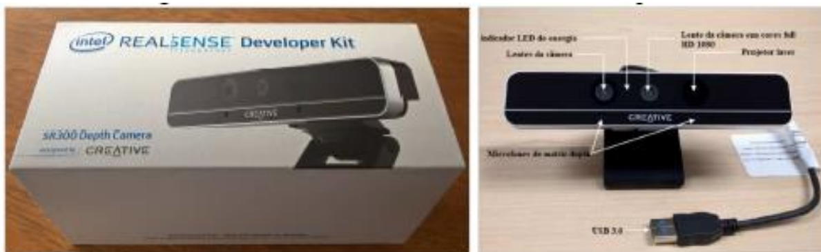
Figura 1 - Câmera Intel® RealSense™ SR300 e suas partes Fonte: Jiménez (2021).
